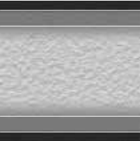
BAR-Beschichtung Eisennitrid Übergangsbereich
