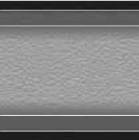
BAR-Beschichtung Eisennitrid Übergangsbereich Durchgehärteter Werkzeugstahl aus Sonderlegierung Siegmund X8.7
